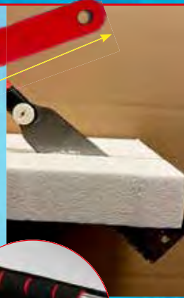
Sierra de tracción japonesa, doblemente dentada
